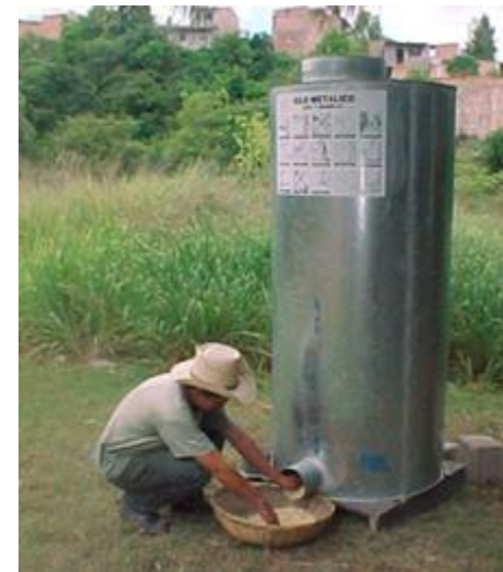
Silos para almacenar granos
